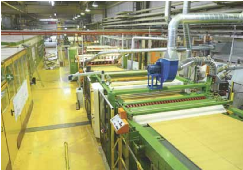
Trockenpartie nach dem Umbau mit revidiertem Querschneider und Vakuum-Auszugsband
